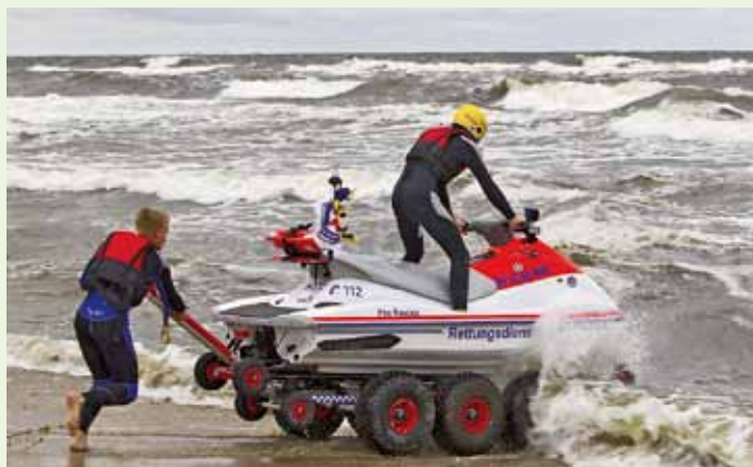
Der neue Slip-Wagen lässt sich leicht über den Strand manövrieren und der Jetski kann bereits gestartet werden, bevor er im Wasser ist. Das kann wichtig sein, wenn Sekunden über ein Menschenleben entscheiden. Foto: Sebastian Drolshagen
